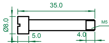
Kurbelbolzen, Aluminium (1x)
